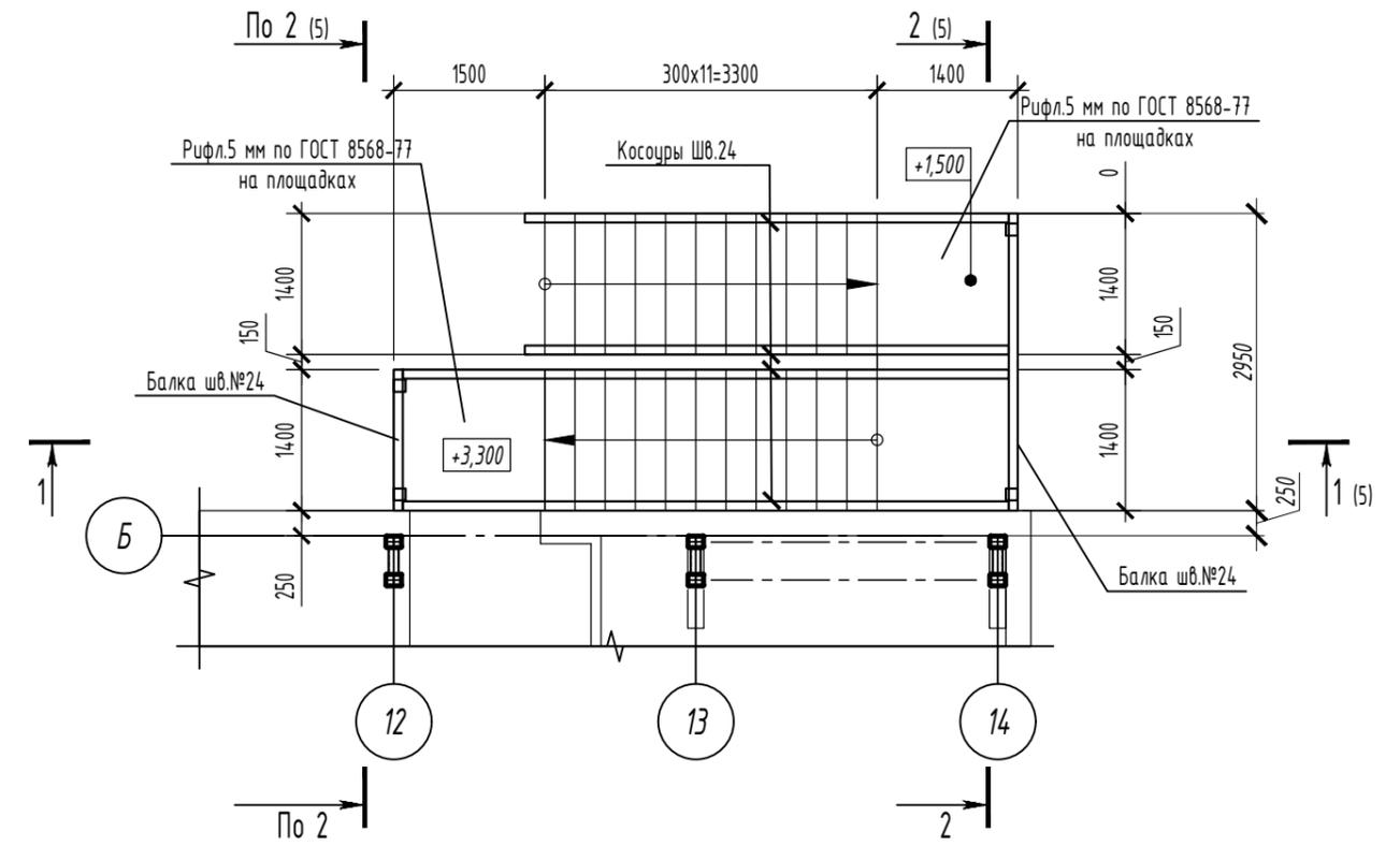
Схема конструкций на отм. 0,000
