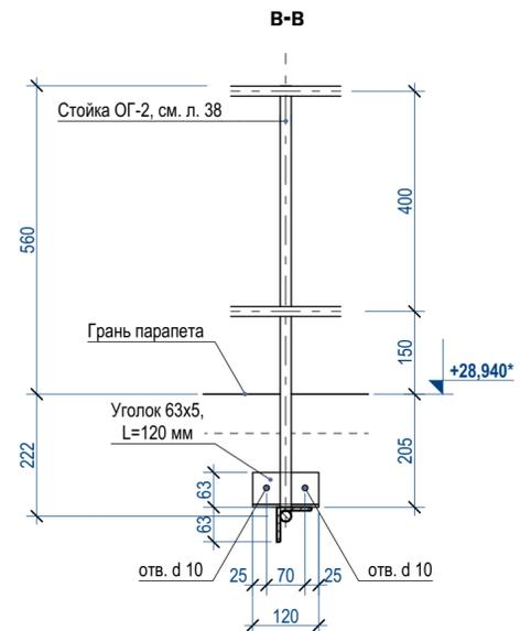
**СПЕЦИФИКАЦИЯ ЭЛЕМЕНТОВ ОГРАЖДЕНИЯ КРОВЛИ**
