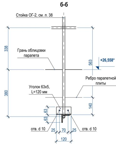
**ДЕТАЛЬ КРЕПЛЕНИЯ СТОЙКИ ОГРАЖДЕНИЯ ОГ-2**
