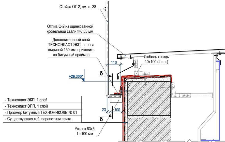
**ДЕТАЛЬ КРЕПЛЕНИЯ СТОЙКИ ОГРАЖДЕНИЯ ОГ-3**
